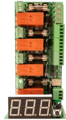
Fire module 4 outputs
